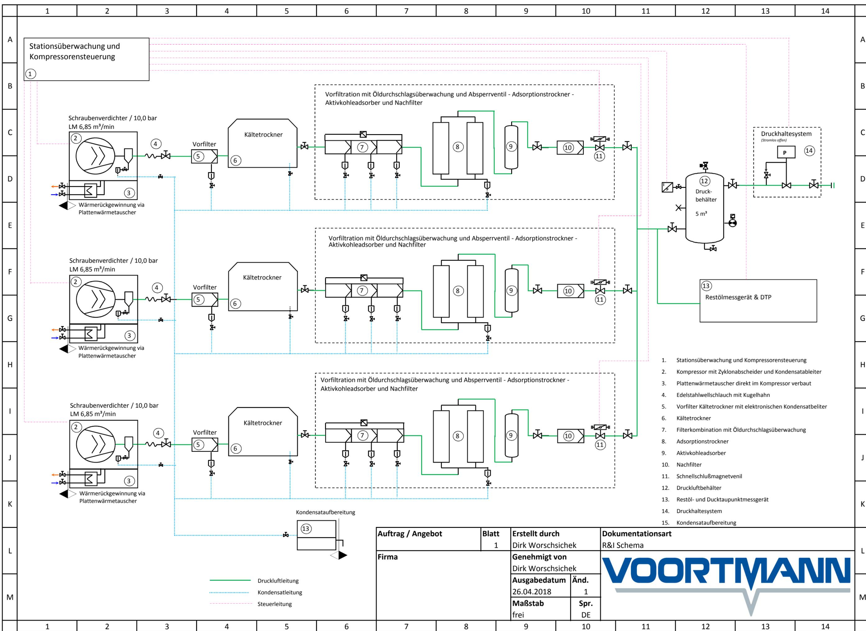
1. Stationsüberwachung und Kompressorensteuerung
