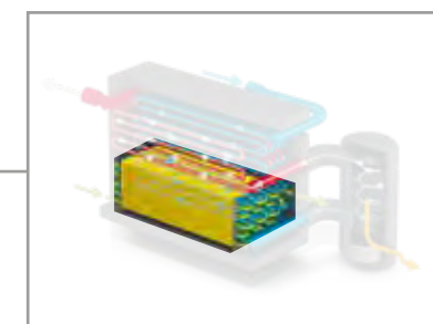
Luft-/Kältemittel-Wärmetauscher mit Kältespeicher (gelber Bereich)
