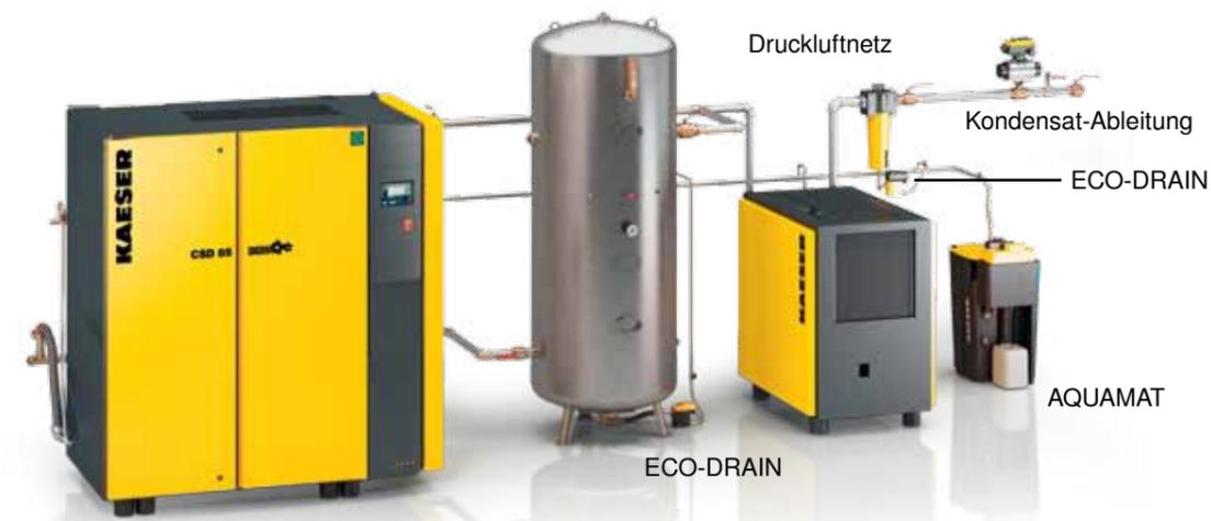
An allen Kondensat-Sammelstellen des Druckluftsystems muss eine zuverlässige Ableitung vorhanden sein. Dies geschieht am besten durch elektronisch geregelte Kondensatableiter.
