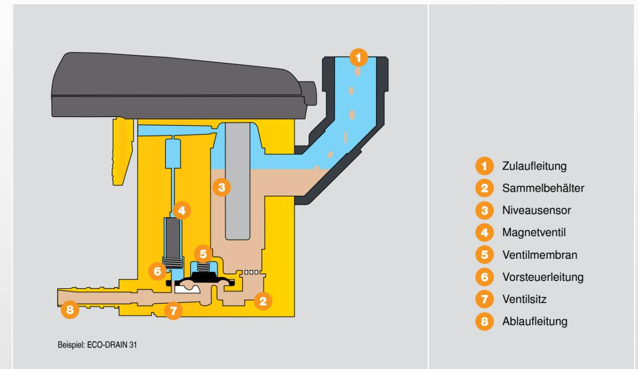
Das Kondensat gelangt über die **Zulaufleitung (1)** in den **Sammelbehälter (2)**. Der kapazitive **Niveausensor (3)** meldet das Erreichen des maximalen Füllstands der Ableitersteuerung. Diese öffnet das **Magnetventil (4)** und damit die **Vorsteuerleitung (6)**. Der daraus resultierende Druckausgleich führt zum Öffnen der **Ventilmembran (5)**. Das Kondensat strömt vom Sammelbehälter durch die **Ablaufleitung (8)** aus dem Ableiter. Sobald das minimale Kondensat-Niveau im
