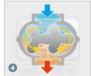
4 Arbeitskammer vollständig entleert
