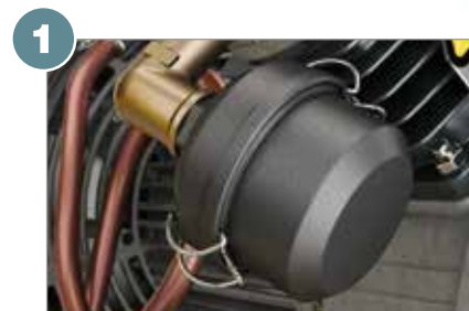
Ansaugluftfilter mit Schalldämpfer
