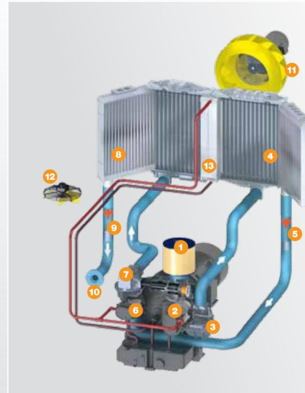
Abb.: Standardausführung DSG-2 – luftgekühlt
