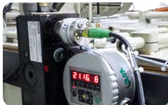
Condition Monitoring liefert permanent Daten zu unterschiedlichsten Parametern wie Temperatur, Füllstand, Druck, Partikel oder Wassersättigung.
