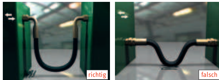
Abbildung 9: Vermeidung von Abrieb durch ausreichende Bewegungsfreiheit
