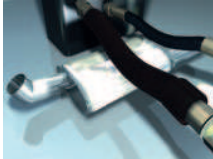
Abbildung 14: Schlauchleitung mit und ohne Hitzeschutz
