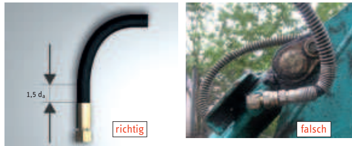
Abbildung 8: richtig - Gerader Abschnitt mit 1,5 d_a vor Biegung falsch - Eine Schlauchscheuerschutzspirale stellt keinen Knickschutz dar
