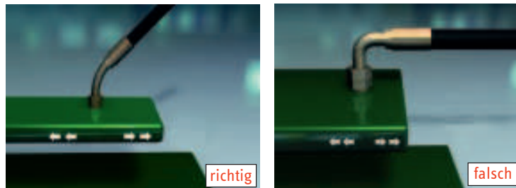
Abbildung 15: Verlegung bei Schwingungen
