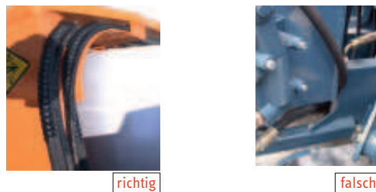
Abbildung 10: Vermeidung von Abknicken oder Scheuern
