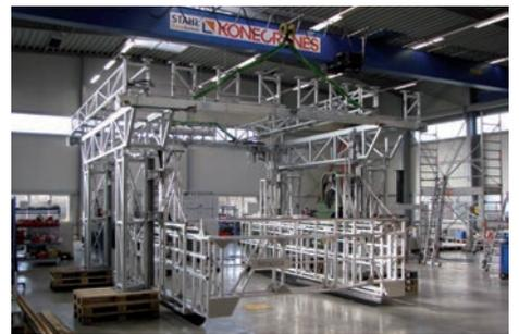
Absturzsicherung einer Verladestation für Tankfahrzeuge - Schutzkorb in U-Form mit Hubeinrichtung und begehbarem Klappgitter
