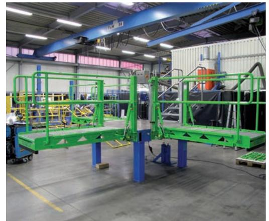
Klapptreppe, hydraulisch, mit säurefestem Spezialanstrich und GFK-Stufen
