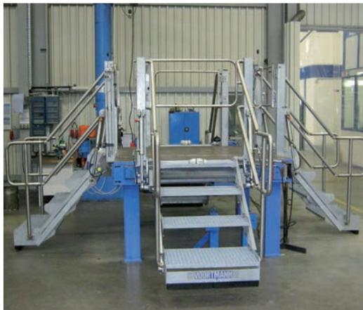
Klapptreppe, hydraulisch, mit Handhebelventil
