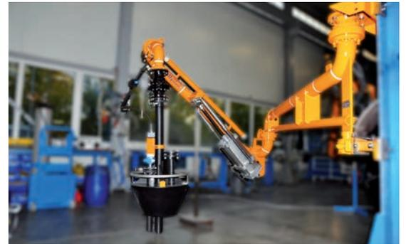
Verlodearm mit Innenauskleidung, DN 80/50, pneumatisch Heben/Senken, Gewichtsausgleich über Gasfedern
